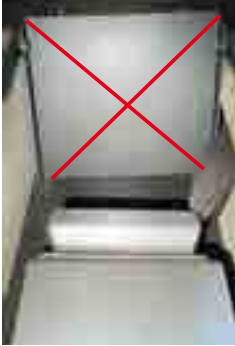
fig. 24 - Posizione errata del deflettore
